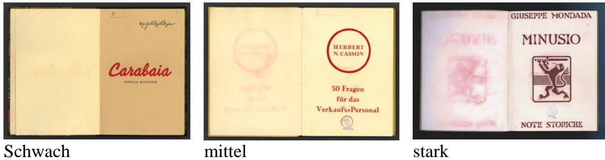
Abbildung 9: Beispiele der Gewichtungen schwach, mittel und stark des Ausbluten von Farbstoffen nach den Richtlinien SLB sind dargestellt.
